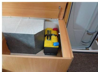
Ci contre, l'installation de la deuxième batterie, dans le coffre à côté de l'entrée.
