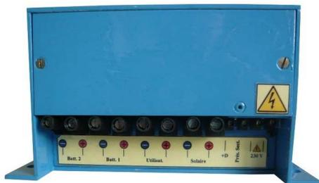
On peut distinguer les connexions de puissance "+" et "-" pour "Batterie1", pour "Batterie2", pour "Panneau solaire" et pour "Utilisation". Des conducteurs de section minimum de 6 mm<sup>2</sup> sont à prévoir, 10 mm<sup>2</sup> étant préférable.
