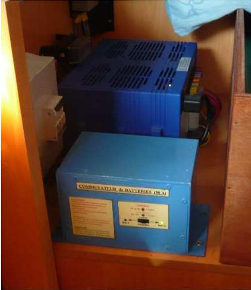
Ce cliché montre le commutateur de batterie installé à proximité du bloc "EBL 269".
